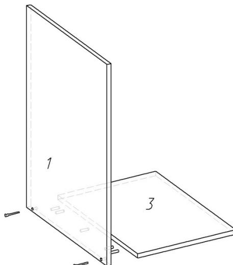
1. Соединить дно и левую поз.1 (или правую поз.2) боковину, *ориентируйте паз под заднюю стенку внутрь корпуса в задней части*. Соединение на 5 шкантов и 2 конфирматы: соедините детали при помощи 5 шкантов, закрепите на 2 конфирмата.
