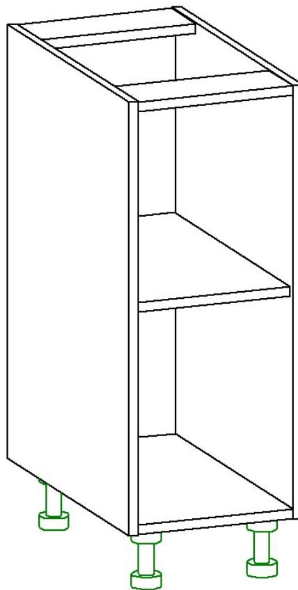
Корпус нижнего шкафа шириной 300мм
