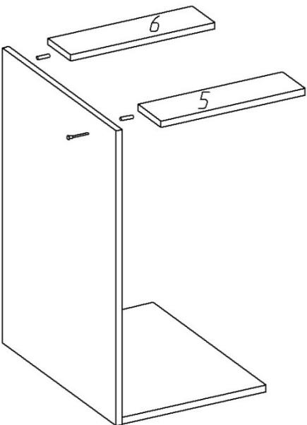
2. Поставить монтажные планки, на 1 шкант каждую. Переднюю монтажную планку закрепить на 1 конфирмат, *заднюю монтажную планку (с пазом) на конфирмат не крепить!*
